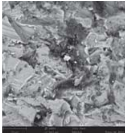
Abb. 32 Oberer Gewindebereich QK Implantat, Trinon (5000x)
